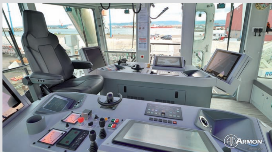
> Visión del puente integrado AlphaBridge Tugboat.
