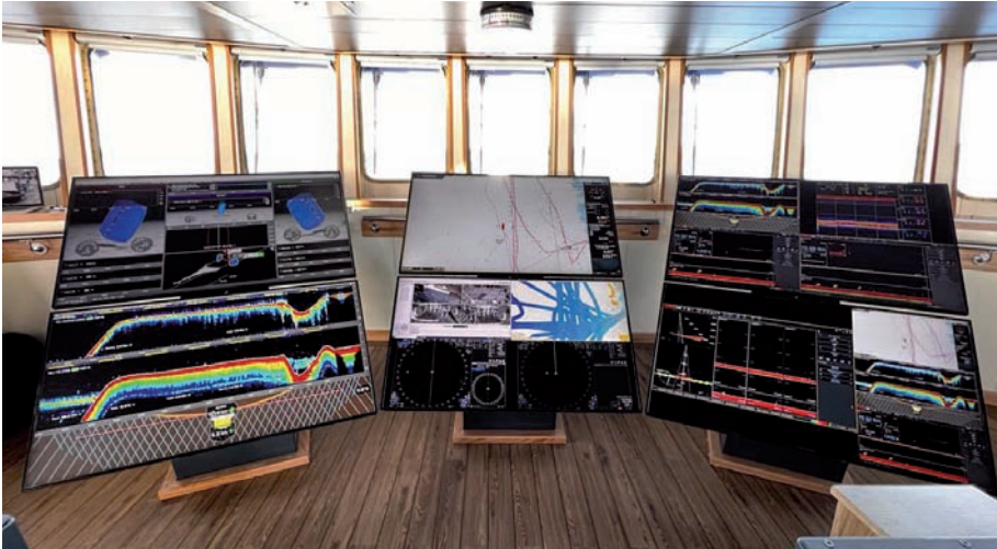
➤ La situación de redes y aparejos es monitorizada permanentemente por los sensores y software de Marport.
