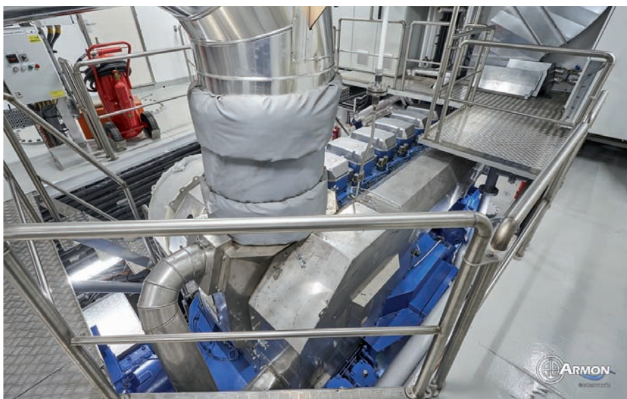
➤ Motor principal de Wärtsilä 6L 32, de seis cilindros en línea.
